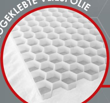
Die Wabenplatten sind mit einer thermogeklebten Vliesfolie ausgestattet, die das Durchwachsen von Unkräutern hemmt und verhindert, dass der Kies unter die Platten gerät.
